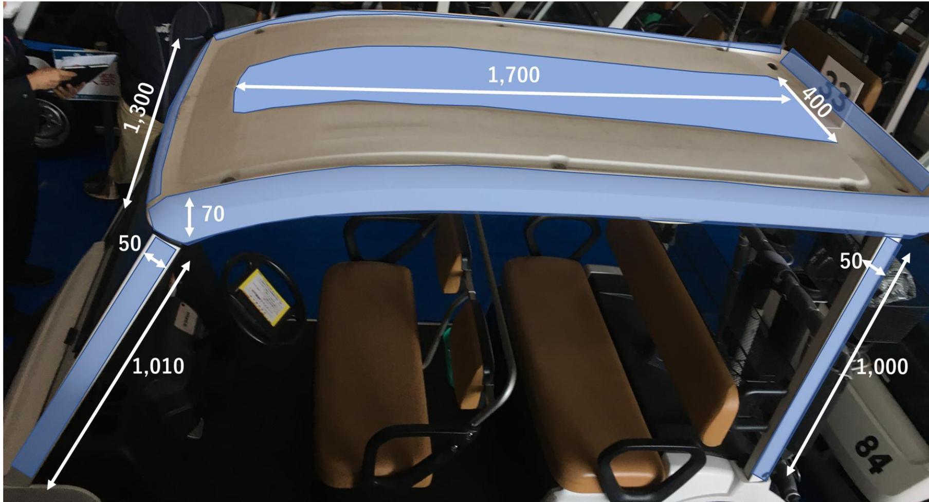
1台塗布面積：2m<sup>2</sup>/台    1ℓ：3回塗りで約20m<sup>2</sup>で積算    20m<sup>2</sup>/ℓ ÷ 2m<sup>2</sup>/台 = 約：**10台/ℓ**
